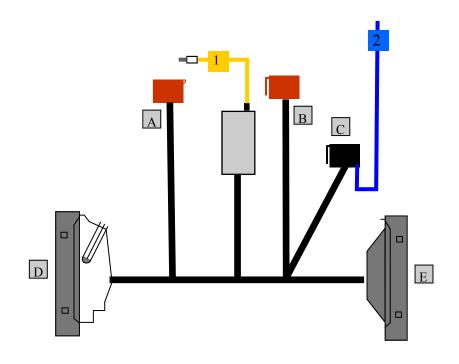
SW101C dispone di un'uscita sottochiave, ARANCIO da collegare al vivavoce. Per ricavare tale uscita,sarà necessario scollegare i connettori A e B in figura e fornire un positivo diretto al filo A isolare il filo B.
