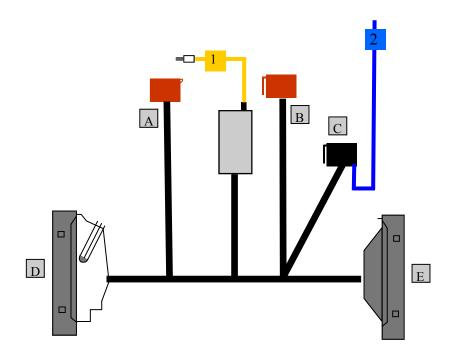
SW101C dispone di un'uscita sottochiave, ARANCIO da collegare al vivavoce. Per ricavare tale uscita,sarà necessario scollegare i connettori A e B in figura e fornire un positivo diretto al filo A isolare il filo B.
